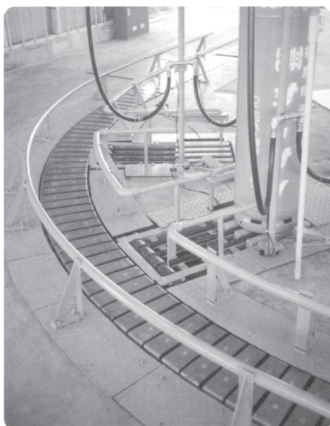
ガスボンベにガスを充填後搬送
