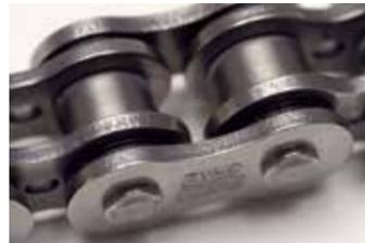
↑外側と内側のプレートにははさまれている黒いゴムがシールリングであり、写真はXリングから発展したQXリングとなる。内部のグリスの封閉と異物の混入を防ぎ、チェーンの寿命を延ばす
