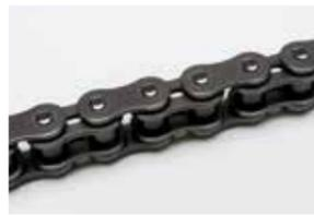
↑Z1で採用されたEKチェーンのシールチェーン。現在も絶版車向けのサイズがラインナップされているが、シールなどはもちろん最新の物が使われている。また、軽量化を目的としたプレートホールも追加される
