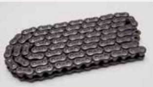
←外觀はZX-10RやZX-14Rと同じスリッドチェーンだが、もちろんニンジャH2/R用の専用品となる。また、ニンジャH2とニンジャH2Rではリンク数が異なるが、チェーン自体は同じ物が使われている
