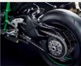
14年に発表されたニンジャH2/Rに純正採用されているのが、江沼チエン製作所のスリッドチェーンである。ニンジャH2/R用チェーンは専用設計であり、その開発には車両コンセプトの段階から加わっていたという。開発段階では今までのモーターサイクル用の試験機、ZX-14Rの開発に使われた物でも対応できず、改良を加えて試験を行なったそうだが、かつてないほどの試験を繰り返したという
